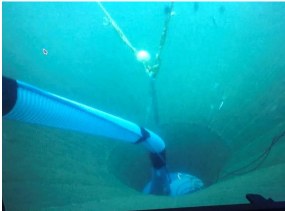
Figur 8 Drone bilde av korrekt LiftUp plassering i notspiss
