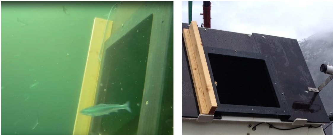
Figur 8: PIT-tag antenner størrelse 60 x 60 cm
