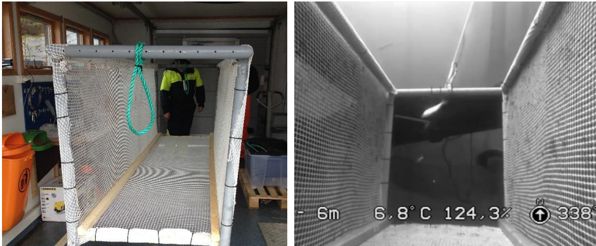
Figur 16: Returåpninger hvor fisken svømmer ut enden på enheten
