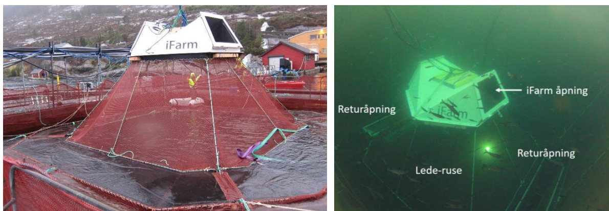
Figur 3: iFarm forkammer, lederuse, bunnring-tube og returåpninger
